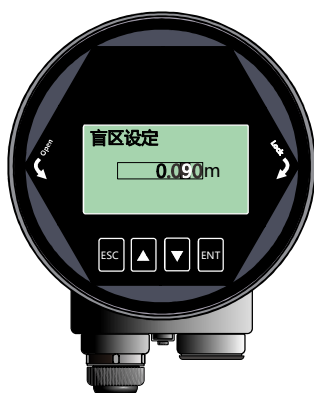
图6-35 【DN】键实现光标处数字修改
